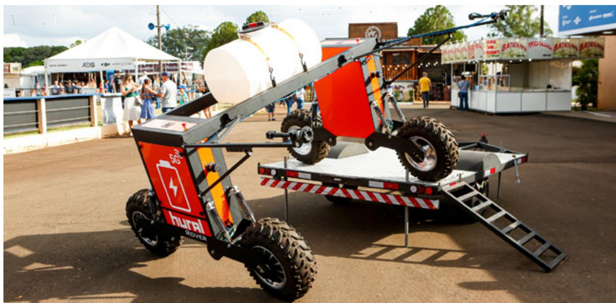
Hural Rover possui baterias capazes de operação contínua por até 3 horas com uma única carga
